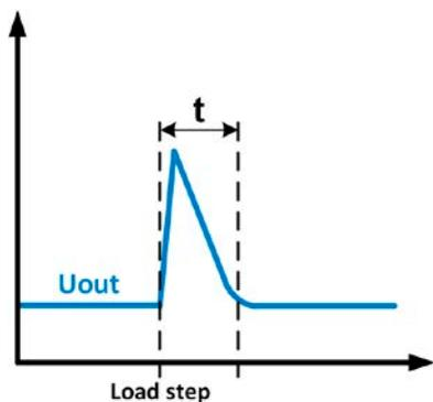
负载负向阶跃举例：直流输出值会在短时间内上升至调节值， $t =$  输出电压稳定的变化时间。
