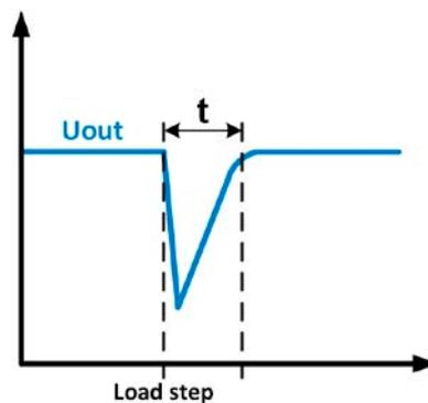
负载正向阶跃举例：直流输出值会在短时间内下降至调节值， $t =$  输出电压稳定的变化时间。
