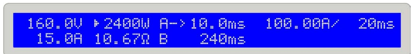
Bild 10. Level A/B-Betrieb mit Pulszeiteinstellung
