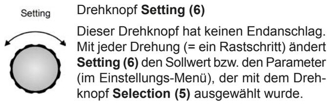
Es gilt: je schneller man den Knopf dreht, desto schneller wird ein Sollwert erhöht oder verringert, die Schrittweite erhöht sich dabei. Mit langsamen Drehbewegungen kann also ein Sollwert in kleinen Schritten verändert werden und mit schnellen Drehbewegungen in großen Schritten.
