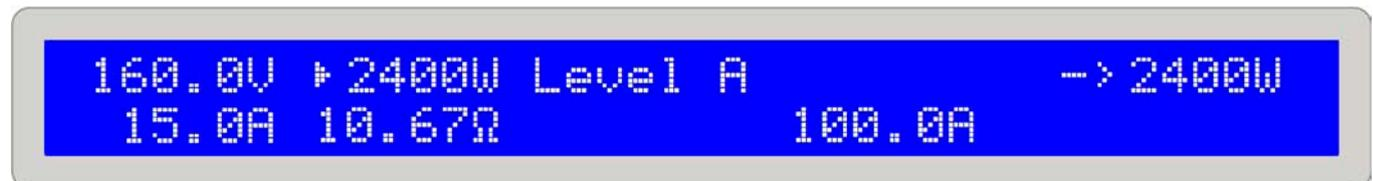
Bild 9. Normaler Lastbetrieb in CP-Regelungsart
