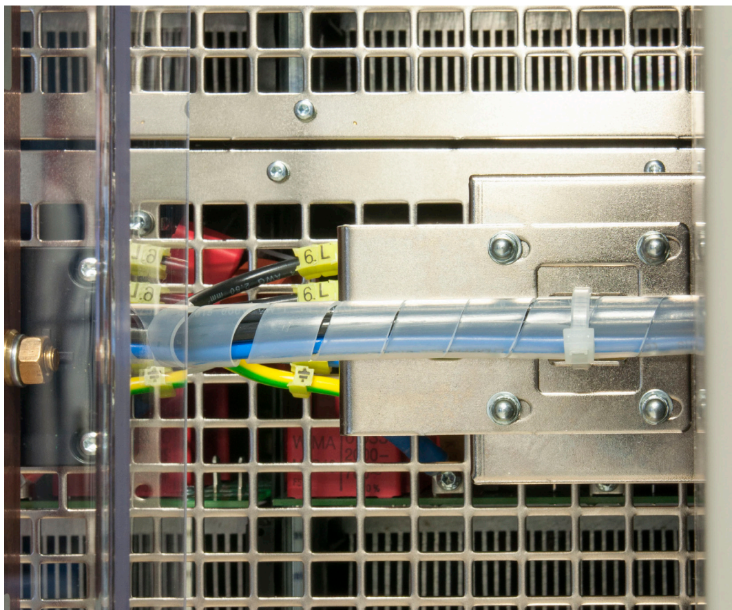
AC_Anschlußstecker der Einzelgeräte, mit Zugentlastung und Fixierung
