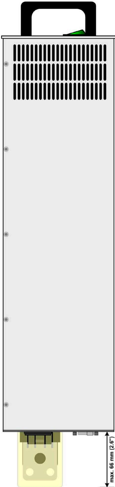
Bild 3 - Seitenansicht von links, mit DC-Abdeckung
