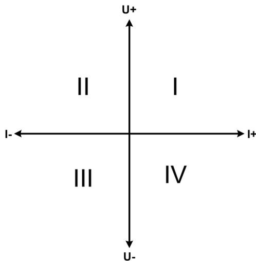
Mit einer Kombination Quelle-Senke können nur die Quadranten I + II abgebildet werden. Dies bedeutet, nur positive Spannungen sind möglich. Der positive Strom wird von der Quelle, ggf. von der Anwendung, generiert und der negative Strom fließt in die Last.
