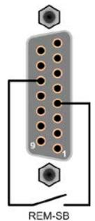
Dieser Eingang wird bei Fernsteuerung zum Ein- und Ausschalten des DC-Anschlusses des Gerätes genutzt. Er funktioniert aber auch ohne aktivierte Fernsteuerung, dann kann er zum Einen das manuelle oder digital ferngesteuerte Einschalten des DC-Anschlusses blockieren und zum Anderen ein- oder ausschalten, jedoch nicht allein. Siehe unten bei „Fernsteuerung wurde nicht aktiviert“.
