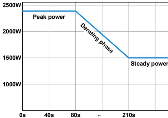
Prinzipielle Darstellung des Derating-Verlaufs anhand eines 2400 W Leistungsmoduls. Modelle dieser Geräteserie können mehrere Leistungsmodule enthalten, die nicht unbedingt alle gleichzeitig mit dem Derating anfangen.
