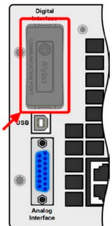
Die Module werden vom Anwender installiert und können problemlos nachgerüstet werden. Gegebenenfalls ist eine Firmware-Aktualisierung des Gerätes erforderlich, damit ein bestimmtes Modul erkannt und unterstützt werden kann.
