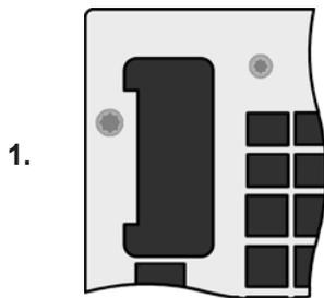
Abdeckung des Schnittstellenslots entfernen. Eventuell einen Schraubendreher zu Hilfe nehmen.
