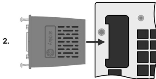
Schnittstellenmodul paßgerecht in den Slot schieben. Es kann aufgrund der Bauform nicht falsch herum gesteckt werden.
