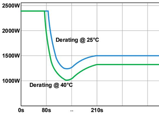
Verlauf des Deratings bei Kaltstart des Gerätes bei 25°C (blau) und bei 40°C (grün) Umgebungstemperatur.
