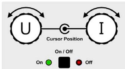
Die physikalischen Einheiten auf den Knöpfen zeigen die Zuordnung an. Der rechte Drehknopf ist bei einer elektronischen Last unveränderlich dem Strom I zugewiesen. Der linke Drehknopf kann durch Antippen der Grafik auf dem Touchscreen umgeschaltet werden.
