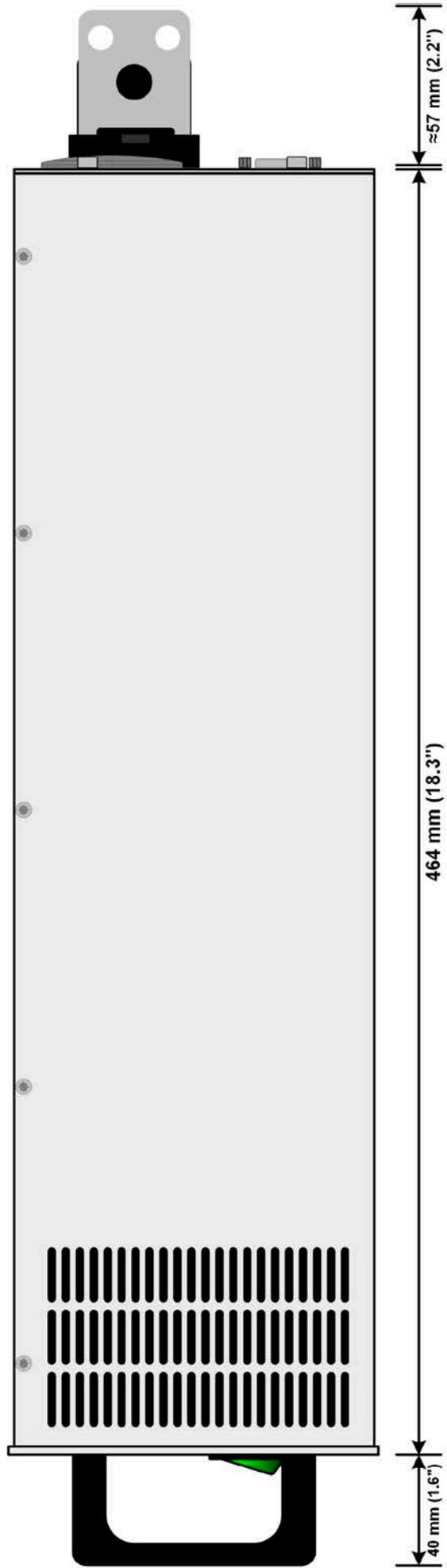
Bild 4 - Seitenansicht von rechts, ohne DC-Abdeckung
