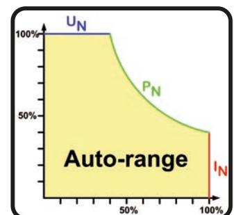
Solange der DC-Eingang eingeschaltet und Konstantleistungsbetrieb aktiv ist, wird der Zustand „CP-Betrieb aktiv“ als Kürzel CP auf der grafischen Anzeige ausgegeben, kann aber auch als Status über die digitalen Schnittstellen ausgelesen werden.
