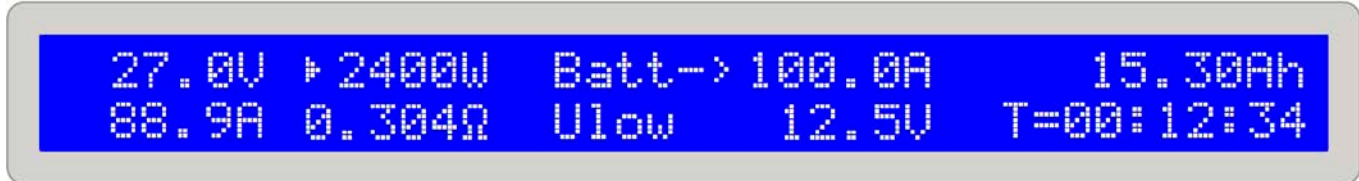
Bild 13. Batterietestbetrieb mit Stromvorgabe
