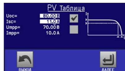
Напряжение MPP (здесь:  $U_{MPP}$ ) лежит обычно на 20% ниже  $U_{OC}$ , ток максимальной точки мощности (здесь:  $I_{MPP}$ ) лежит обычно 10% ниже  $I_{SC}$ . В случае, если нет доступных определённых значений для симулирования солнечных элементов, то  $I_{MPP}$  и  $U_{MPP}$  могут быть установлены этими типовыми значениями. Устройство ограничивает значение  $I_{MPP}$  к  $I_{SC}$  как верхний лимит, тоже самое применяется для  $U_{MPP}$  и  $U_{OC}$ .
