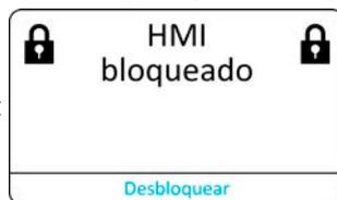
3. Desbloquee el HMI al pulsar en **Desbloquear** en menos de 5 s o la ventana emergente desaparecerá y el HMI permanecerá bloqueado. En caso de que se haya activado un bloqueo mediante código PIN la pantalla **Bloqueo**, aparecerá otra ventana emergente solicitándole introducir el PIN antes de desbloquear el HMI.
