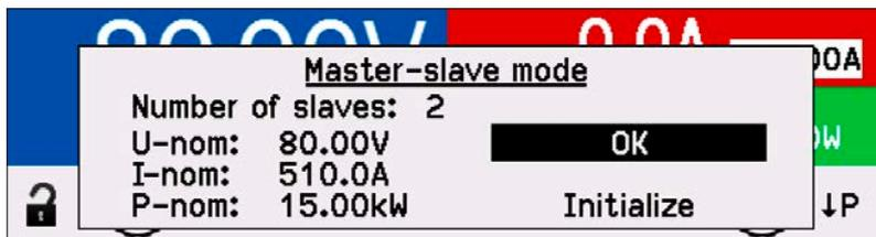
La pantalla de ejemplo muestra que las dos esclavas se han inicializado y, por lo tanto, hay un total de tres unidades con 510 A de corriente y 15 kW de potencia. El sistema MS consta de tres unidades del modelo PSE 9080-170 WR.
