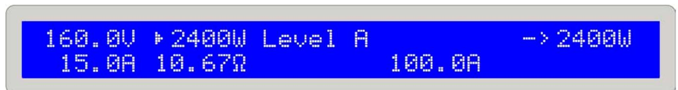
Bild 9. Normaler Lastbetrieb in CP-Regelungsart
