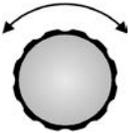
Dieser Drehknopf hat keinen Endanschlag. Mit jeder Drehung (= ein Rastschritt) ändert **Setting (6)** den Sollwert bzw. den Parameter (im Einstellungs-Menü), der mit dem Drehknopf **Selection (5)** ausgewählt wurde.
