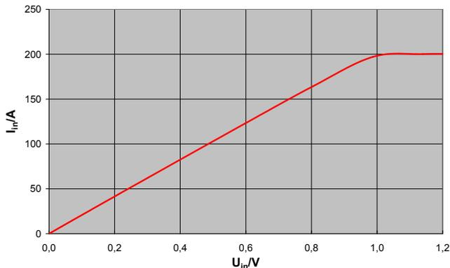
Der Spannungsverlauf zwischen 0 und  $U_{\min}$  ist linear und daher kann der machbare Strom bei noch kleineren Spannungen berechnet werden. Für den  $I_{\max}$  gilt folgende  $U_{\min}$ :
