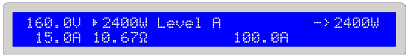
Рисунок 9. Нормальная работа нагрузки в режиме регулирования CP
