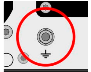
Figure 12 - Point de mise à la terre
