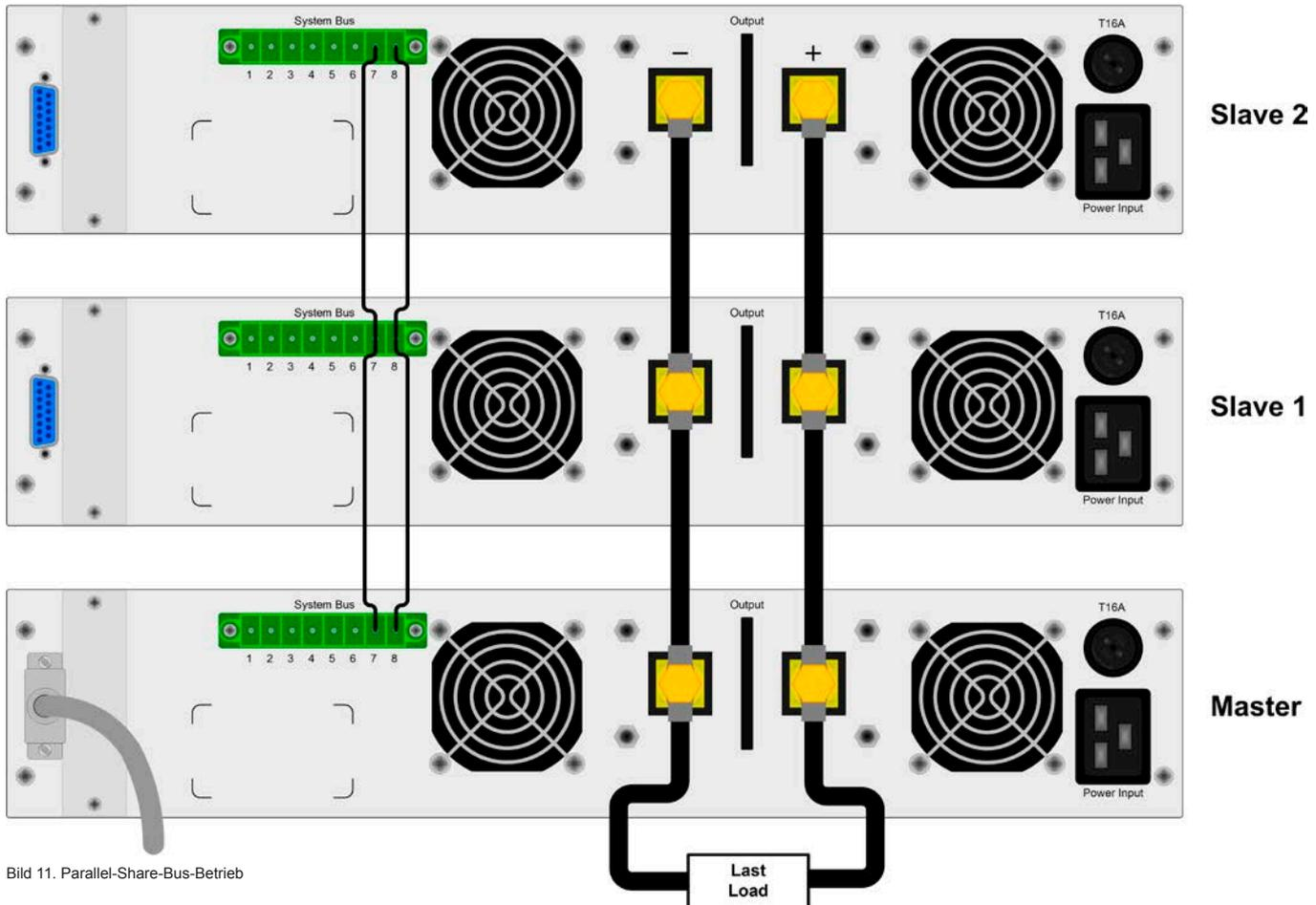
Bild 11. Parallel-Share-Bus-Betrieb
