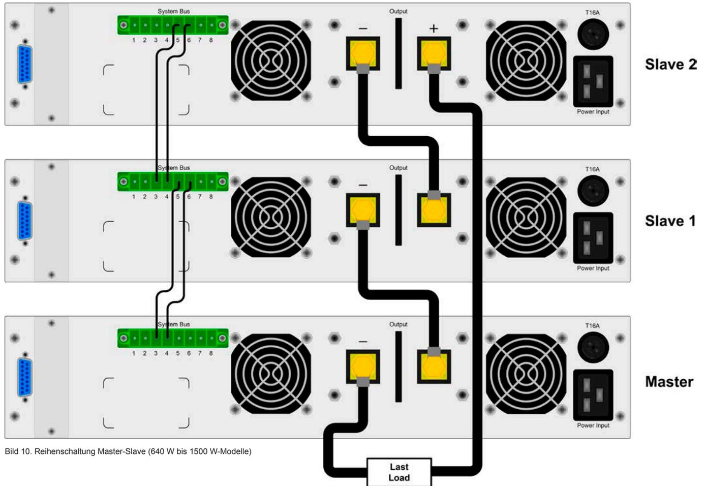
Bild 10. Reihenschaltung Master-Slave (640 W bis 1500 W-Modelle)
