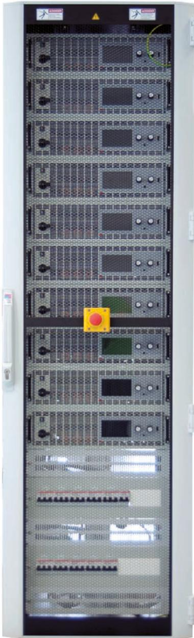
Châssis 42U avec arrêt d'urgence et 10x ELR 9000 /
