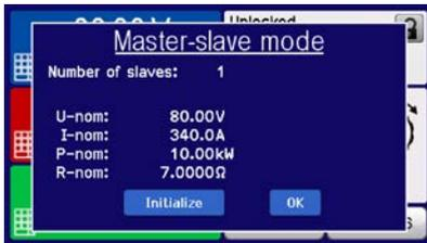
L'appui sur INITIALIZE peut être utilisé pour répéter la recherche, dans le cas où le nombre d'esclaves détecté est inférieur à celui attendu. Cela peut être nécessaire si toutes les unités ne sont pas réglées comme ESCLAVE ou que le câblage n'est encore pas correct. La fenêtre de résultat indique le nombre d'esclaves, le courant total et la puissance du système Maître-esclave.
