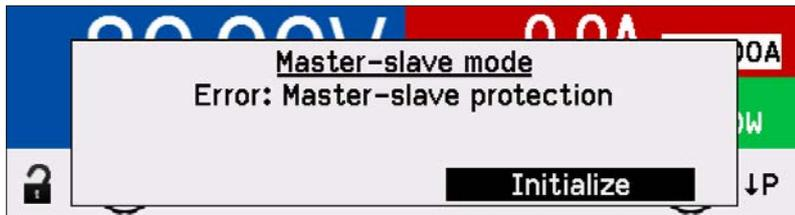
Ensuite, le système maître / esclave devra être réinitialisé, avec ou sans rétablissement de la connexion à l'unité déconnectée.
