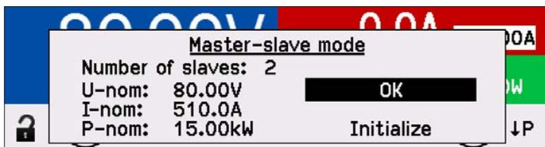
L'exemple montre que deux esclaves ont été initialisés, d'où un total de trois unités avec un courant de 510 A et une puissance de 15 kW. Le système MS se compose de trois unités du modèle PSE 9080-170.
