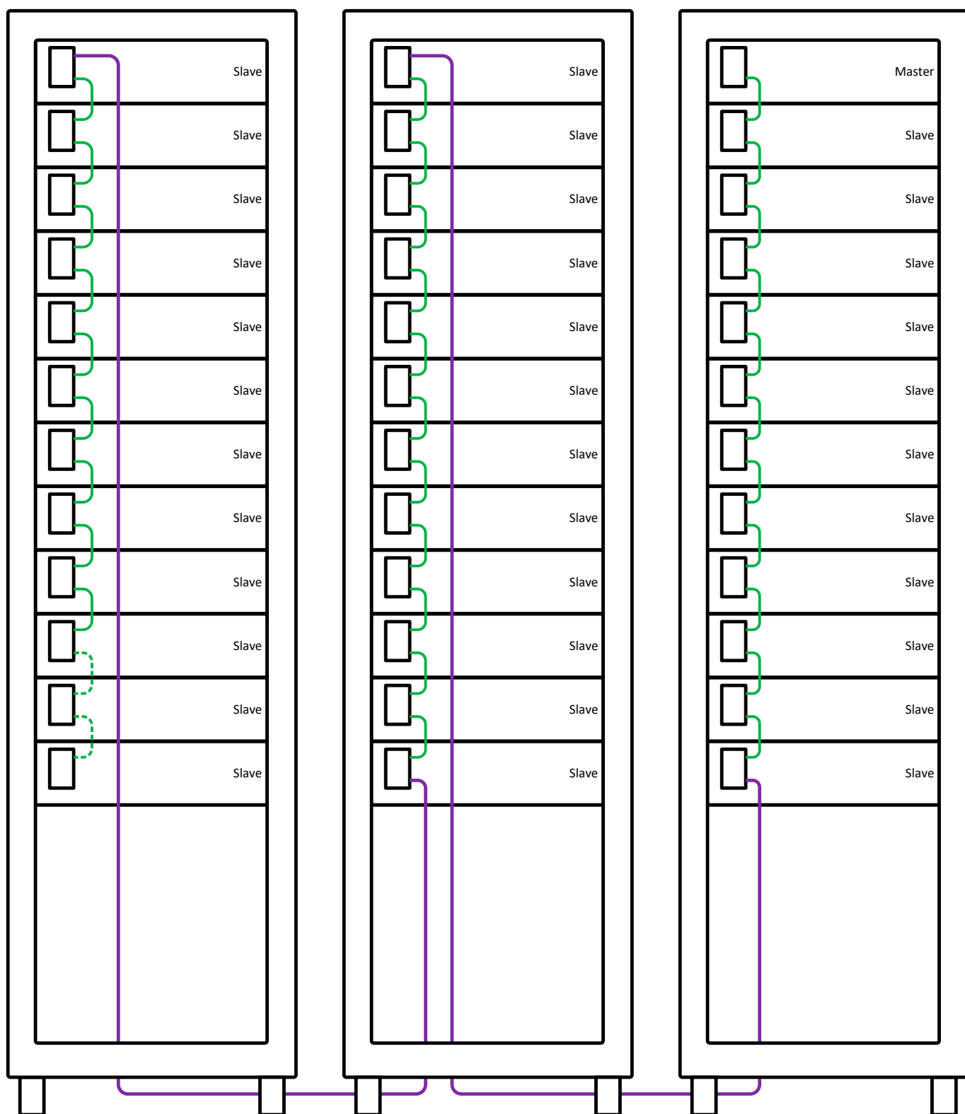
Bild 3 - Schema der Share-Bus-Verdrahtung (von hinten gesehen) Figure 3 - Share bus wiring scheme (seen from the rear)
