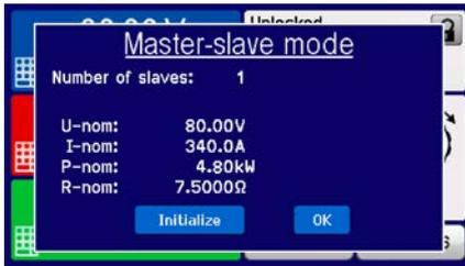
Al pulsar en **Initialize** se repite la búsqueda de esclavas en el caso de que se hayan detectado un número menor de esclavas de lo esperado, el sistema se haya reconfigurado, no todas las esclavas estén configuradas como **Slave** o el cableado/terminación siga sin ser correcto. La ventana de resultados muestra el número de unidades esclavas, así como la corriente, potencia y resistencia totales del sistema MS.
