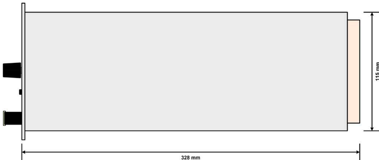
Imagen 6 - Vista lateral del módulo de carga
