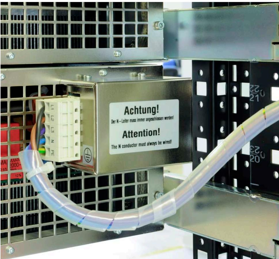
Abb. 4 - AC-Anschluß der Einzelgeräte
