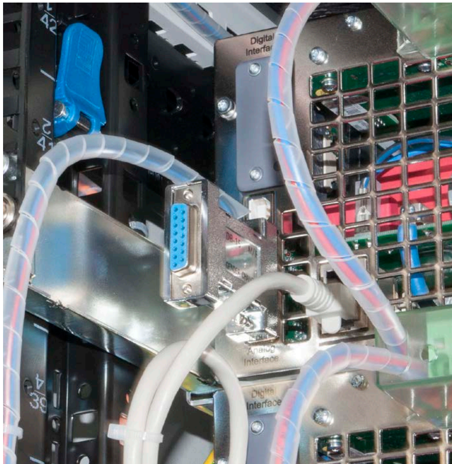
Bild 3. Adapterstecker für analoge Schnittstelle, zur Ansteuerung des Signals Rot (Signalsäule)
