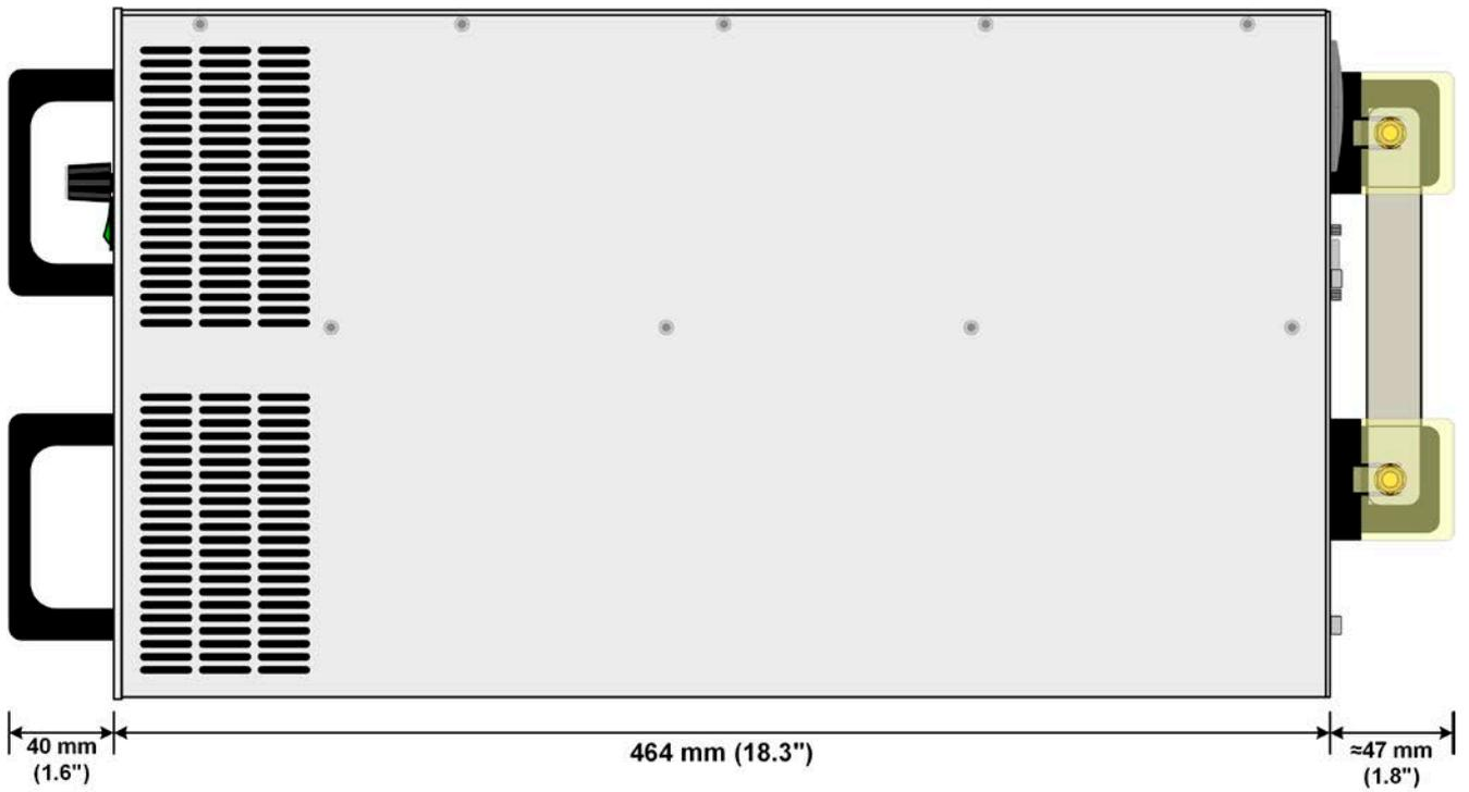
Imagen 8 - Vista lateral, con cubierta DC (modelos con tensiones nominales de 500 V o 750 V)
