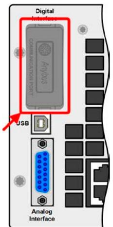
Los módulos se instalan por parte del usuario y se pueden actualizar sin problemas. Puede ser necesario una actualización de firmware con el fin de reconocer y respaldar ciertos módulos.
