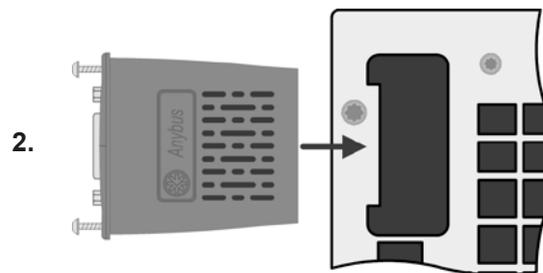
2. Inserte el módulo de interfaz en la ranura. La forma garantiza una correcta alineación.
