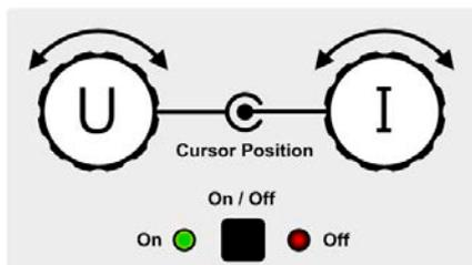
Las cantidades físicas en la imagen del mando muestran la asignación real. Con una carga electrónica, el mando derecho siempre está asignado a la corriente I mientras que el mando izquierdo se puede modificar al pulsar en la imagen.
