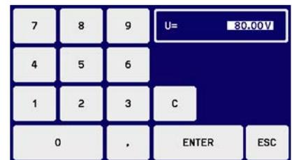
2. Introduzca el valor requerido mediante el teclado decimal. De la misma forma que en una calculadora de bolsillo, la tecla **c** borra los datos de entrada.
