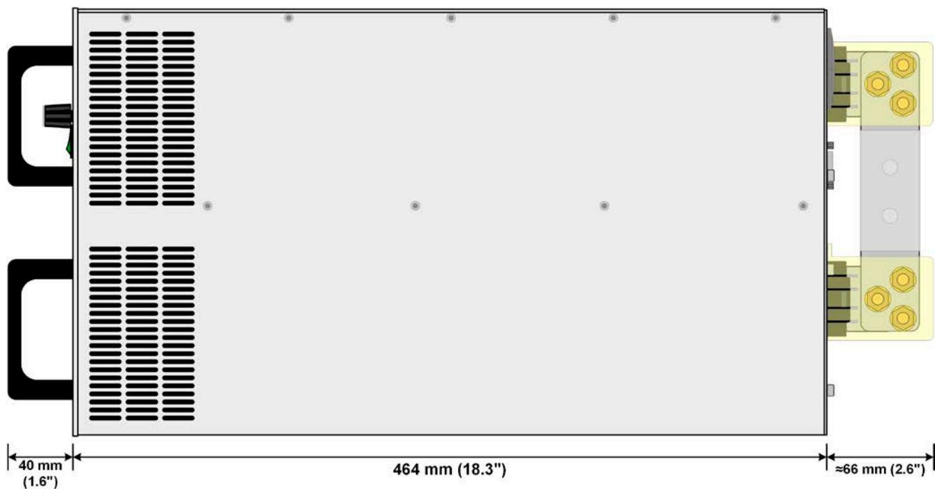
Imagen 10 - Vista lateral, con cubierta DC (modelos con tensiones nominales de hasta 360 V)
