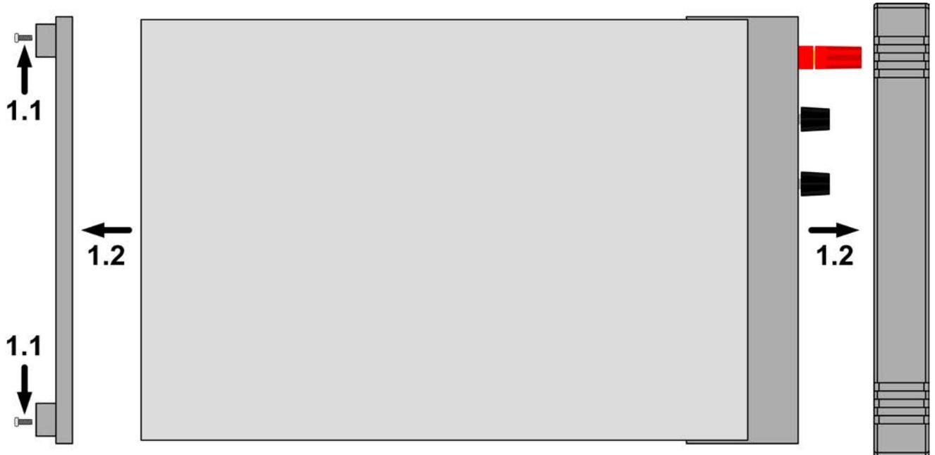
Figure 7 - Retrait des encadrements avant et arrière
