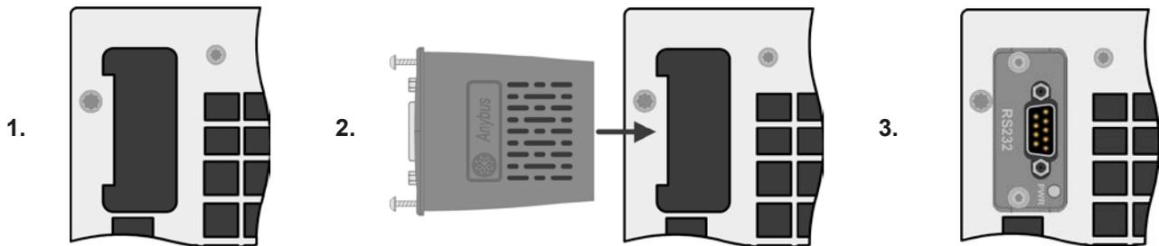
1. Retirez le couvercle. Si nécessaire, utilisez un tournevis.
