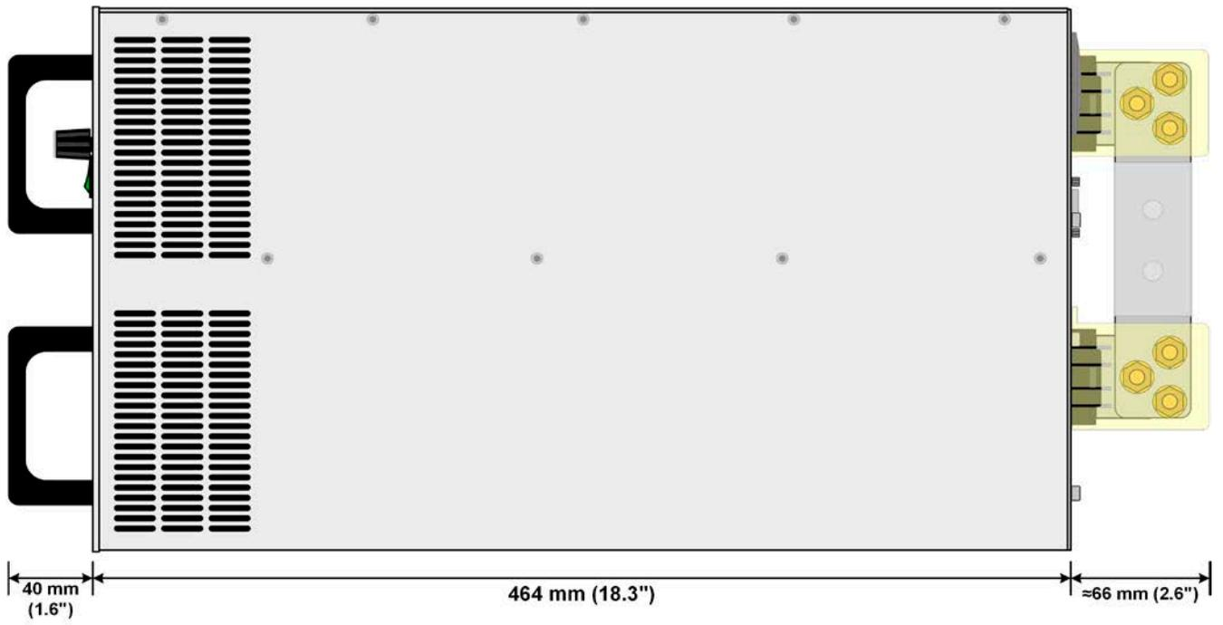
Figure 10 - Vue de côté, avec couvercle DC (modèles avec tension admissible de 80 V jusqu'à 360 V)
