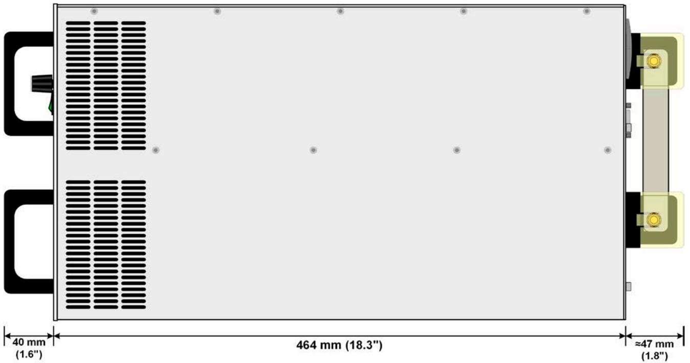
Figure 8 - Vue de côté, avec couvercle DC (modèles avec tension admissible 500 V ou 750 V)
