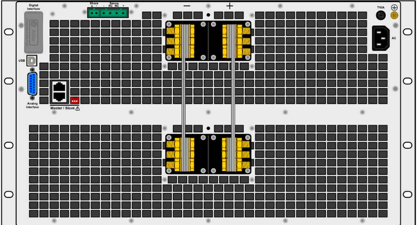
Figure 9 - Vue arrière, sans couvercle DC (modèles avec tension admissible de 80 V jusqu'à 360 V)
