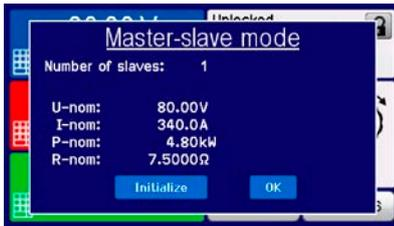
Un appui sur **Initialize** répète la recherche d'esclaves au cas où le nombre d'esclaves trouvés est inférieur à ce qui est prévu, le système a été reconfiguré, l'ensemble des unités esclaves n'est pas configuré comme **Slave** ou le câblage / terminaison n'est pas encore OK. La fenêtre de résultat indique le nombre d'esclaves, plus le courant, la puissance et la résistance totale du système ME.
