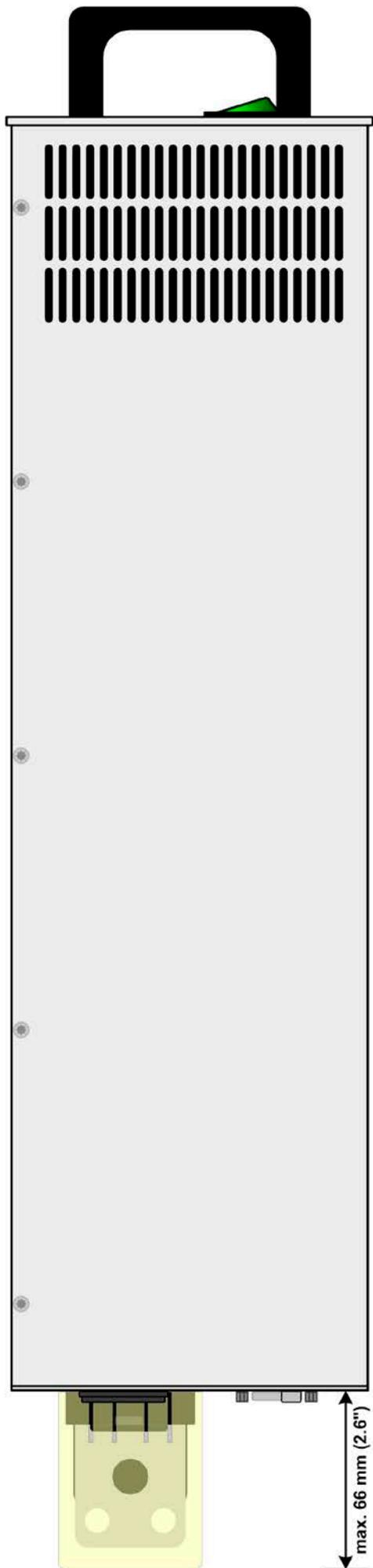
Figure 3 - Vue de côté (gauche) avec couvercle DC
