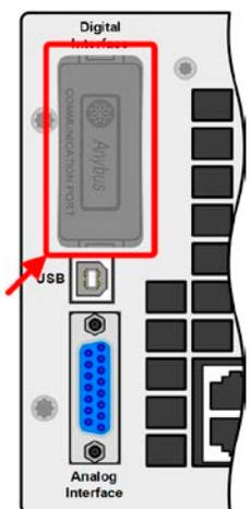
Les modules sont installés par l'utilisateur et peuvent être retirés sans soucis. Une mise à jour du firmware de l'appareil peut être nécessaire afin de reconnaître et vérifier la compatibilité de certains modules.
