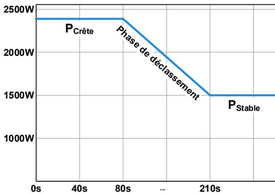
Principe de réduction, illustré sur l'exemple d'un étage de puissance de 2400 W. Les modèles de cette série peuvent avoir plusieurs étages de puissance, qui ne sont pas nécessairement démarrés en même temps.
