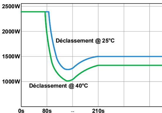
Évolution de la réduction après un démarrage à froid de l'appareil à température ambiante de 25°C (77 °F, bleu) et 40°C (vert).
