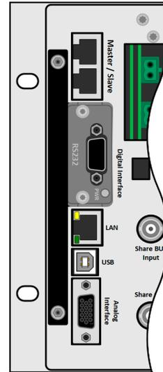
随附的螺丝 (Torx 8) 用于固定模块，应完全拧入并锁紧。安装完成后，模块即可随时使用和连接。
