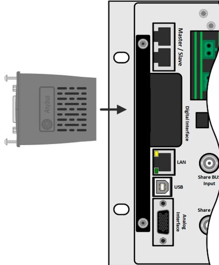
将接口模块插入槽位。插槽形状可保证正确对齐。
