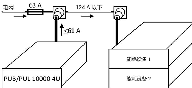
如果在同一供电段上运行更多的回收设备,即能量回馈设备,每相的总电流也会相应增加。
