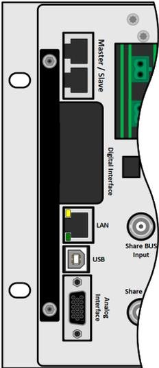
取下槽盖。如果需要，允许使用螺丝刀拆卸。
