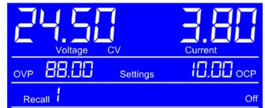
Beim Verwerfen werden die zuletzt gespeicherten Werte nicht überschrieben. Nach Betätigung einer der beiden Tasten verläßt das Gerät zunächst den Recall-Modus.
