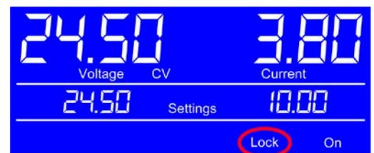
Der Zustand LOCK bleibt so lange erhalten, bis Sie ihn wieder beenden, auch wenn Sie zwischendurch in Fernsteuerung und wieder zurückwechseln würden, oder bis das Gerät ausgeschaltet wird. Die Sperre der Bedieneinheit dabei wird nicht gespeichert. Um sie zu entsperren, muß nur die Taste **Lock** erneut betätigt werden.
