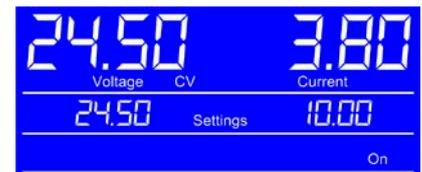
Durch die Bedienfeldsperre „Lock“ (siehe 3.4.7) kann die Verstellung der Sollwerte blockiert sein.
