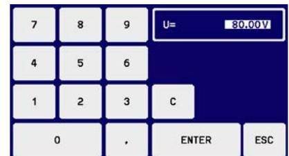
Los valores decimales se ajustan pulsando la tecla del punto. Por ejemplo, 54,3 V se introduce con **5** **4** **.** **3** y **ENTER**.
