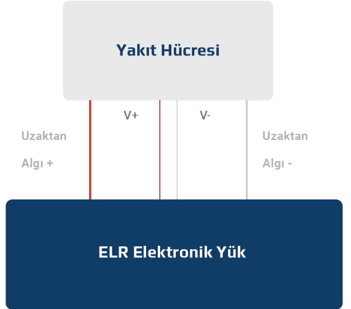
Şekil 4 Yakıt hücresi direncini akım kesme yöntemiyle ölçmek için test kurulumu
